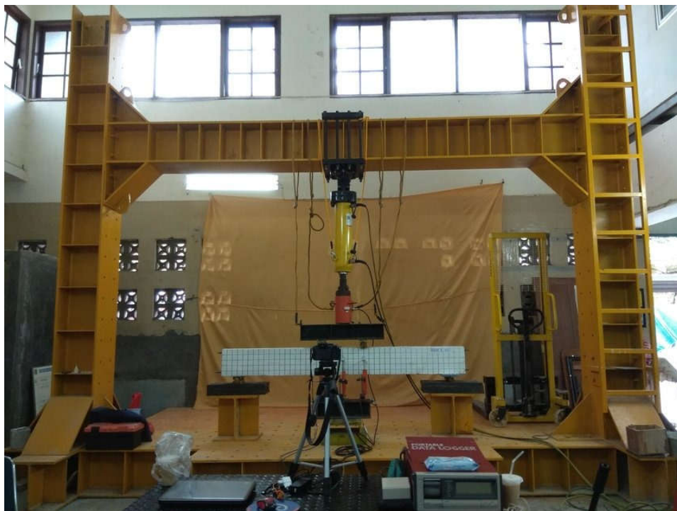
Frame dan Set-up Pengujian Komponen Struktur dengan Hydraulic Jack Double Acting Cylinder (Pembebanan monotonic maupun siklik dapat dilakukan secara Horizontal atau Vertikal)
